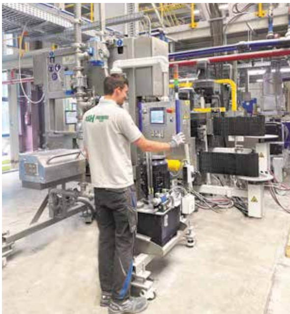
Ein Schichtführer bei RSH POLYMERE bei der Inbetriebnahme der neuen Unterwasseranlage vom Typ ips-UWG 120 S.
