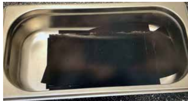
Edelmetallbeschichtete Membranen (CCM)
